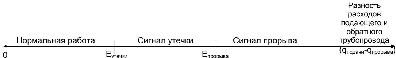
Рисунок 3 – Критерий оценки протечки и прорыва трубопровода
